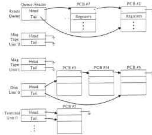
Si un proceso que se está ejecutando debe esperar que se complete una operación de I/O, entonces es colocado en otra cola, llamada *device queue*. Cada dispositivo tiene su propia *device queue*.
