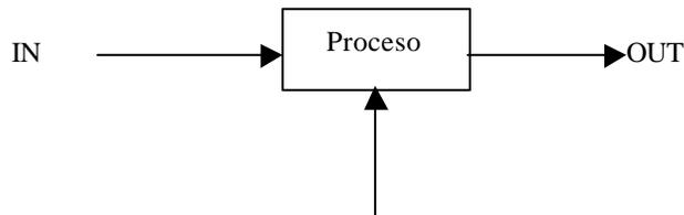
Ejemplo: bajar la temperatura cuando calienta el termotanque. Hay un proceso que hace variar la salida de acuerdo a la entrada, pero en ningún momento se verifica si la salida es la deseada.
