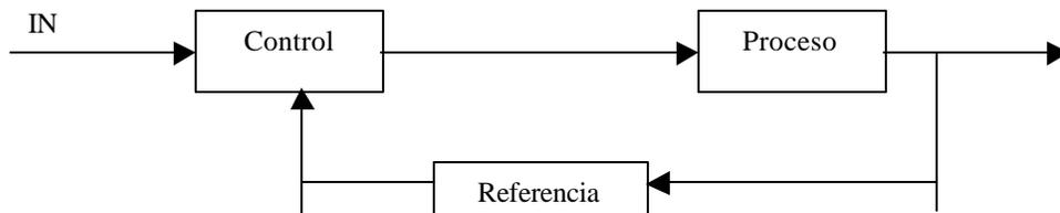
Ejemplo: combinar el agua fría y el agua caliente en una ducha de manera de obtener la temperatura correcta. Se va agregando agua caliente (o fría) y se va “testeando” la salida de la ducha mediante el tacto para comprobar si se tiene la salida requerida. El resultado del “test” se utiliza para saber si al instante siguiente se agregará mayor cantidad de agua caliente o de agua fría.
