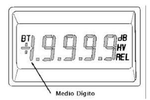
Cada dígito será formado por la combinación de los segmentos de ese dígito. Cada segmento es controlado por una línea eléctrica. Para tener mayor resolución de lectura, se necesitan varios dígitos, pero cada dígito necesita 7 líneas. Esto complica la decodificación y la implementación eléctrica del contador por la cantidad de cableados necesarios.
