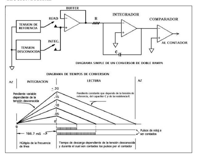
El proceso entero de conversión Analógico a Digital es conseguido a través un circuito integrado que posee las funciones de conversor A/D y los excitadores de presentación.
