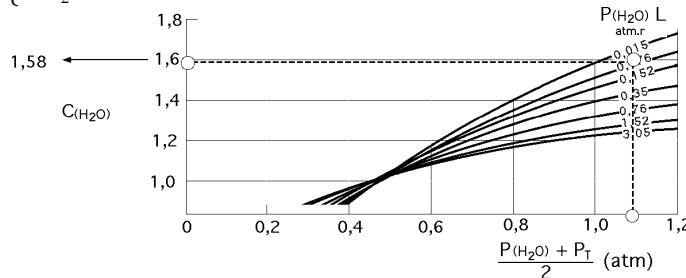
Factor de corrección de la emisividad del vapor de H<sub>2</sub>O a presiones distintas de 1 atmósfera
