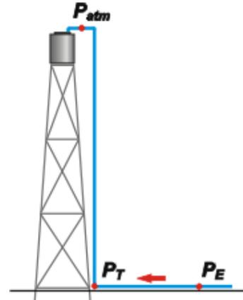
En el tanque, no nos interesa que el agua esté bajo presión, aunque inevitablemente va a estar presionada por la atmósfera (no tendría sentido fabricar tanques herméticos).
