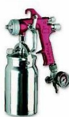
pasa por la desembocadura de un tubo cuyo extremo inferior está sumergido en el depósito de pintura, igual que estaría una chimenea con una abertura dentro de la vivienda y el otro sobre el techo. La diferencia de presión entre el interior y el exterior hace que la columna de pintura ascienda y al alcanzar la corriente de aire es arrastrado y pulverizado por éste.
