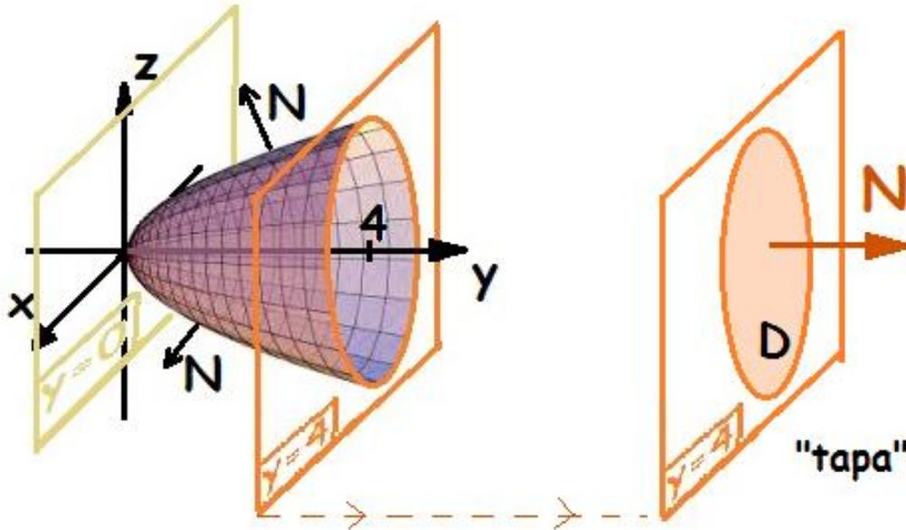
Para calcular el flujo analizo si se cumplen las hipótesis del Teorema de Gauss (o de la divergencia). Para eso "cierro" la superficie  $\Sigma$  con una tapa (un disco de radio máximo 2 centrado en  $(0,4,0)$ ) que la voy a llamar D para formar la frontera del cuerpo W.
